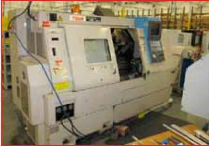
**MAZAK SQT15MS MARK II CNC LATHE**
